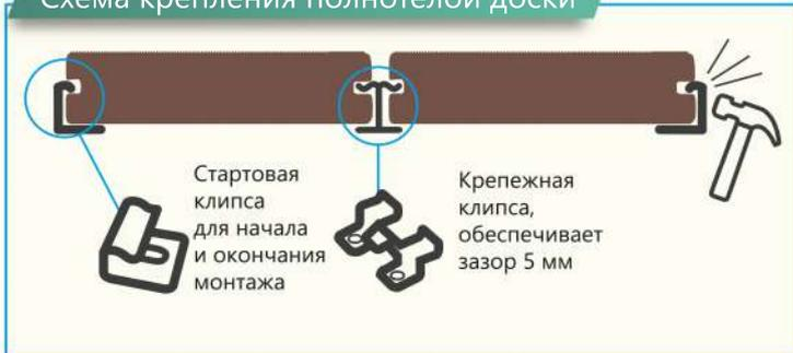
Схема скрытого крепления
