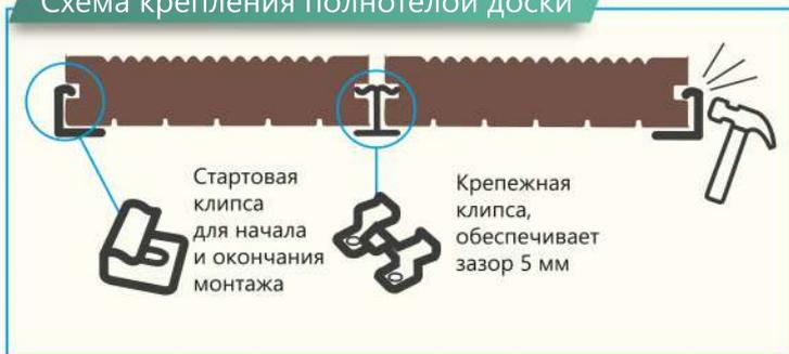
Схема скрытого крепления
