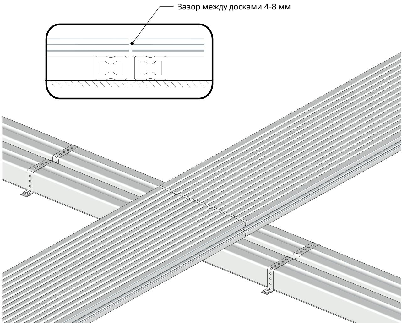
В серии **WOODVEX Select** и **Select colorite** есть возможность завершить настил стартовой(финишной) клипсой. Для этого необходимо разметить расстояние до края последней доски, закрепить клипсы на этом расстоянии, и защелкнуть в них доску так, как показано на рисунке.
