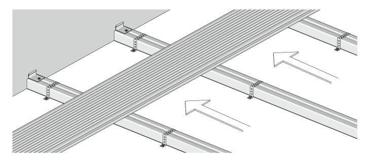
Для равномерного зазора и полного прилегания доски используйте киянку. **ВАЖНО -** Не подбивайте доски вплотную друг к другу, это нарушит отток воды с поверхности и вентиляцию настила.
