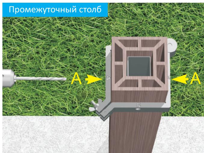
Внимание! Отверстия в шаблоне расположены на разных высотах. Устанавливайте шаблон на каждый столб, в одинаковом положении на одной высоте.
